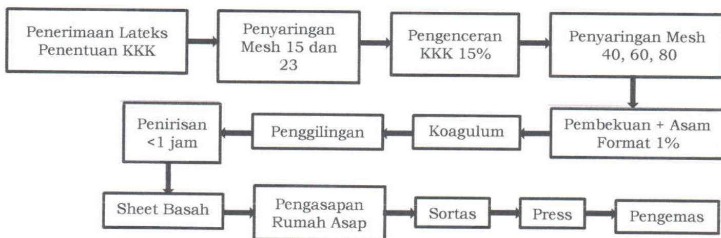
Gambar 6. Diagram Alir Proses Pengolahan Karet Lembaran
