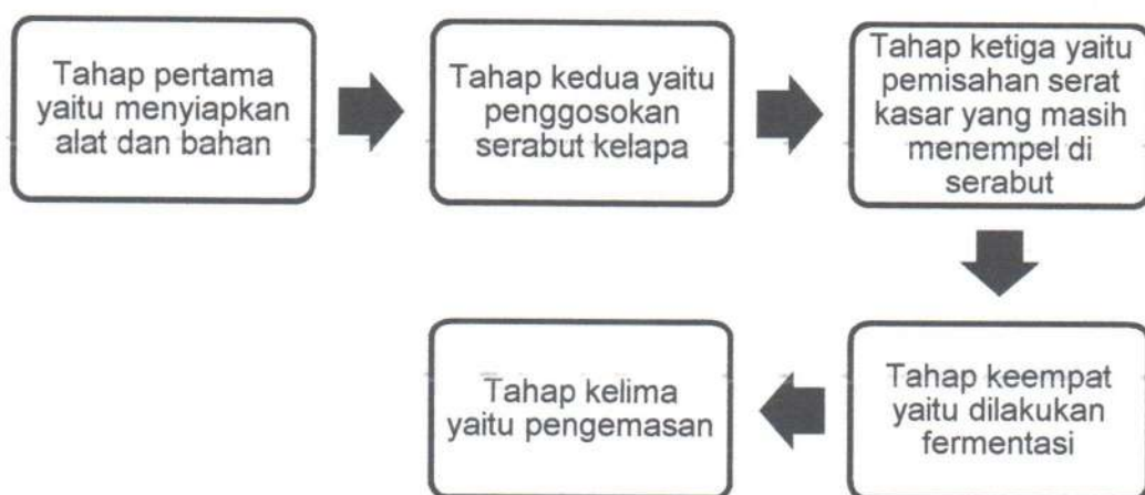
Gambar 15. Tahapan Proses Pengolahan Limbah Serabut Kelapa
